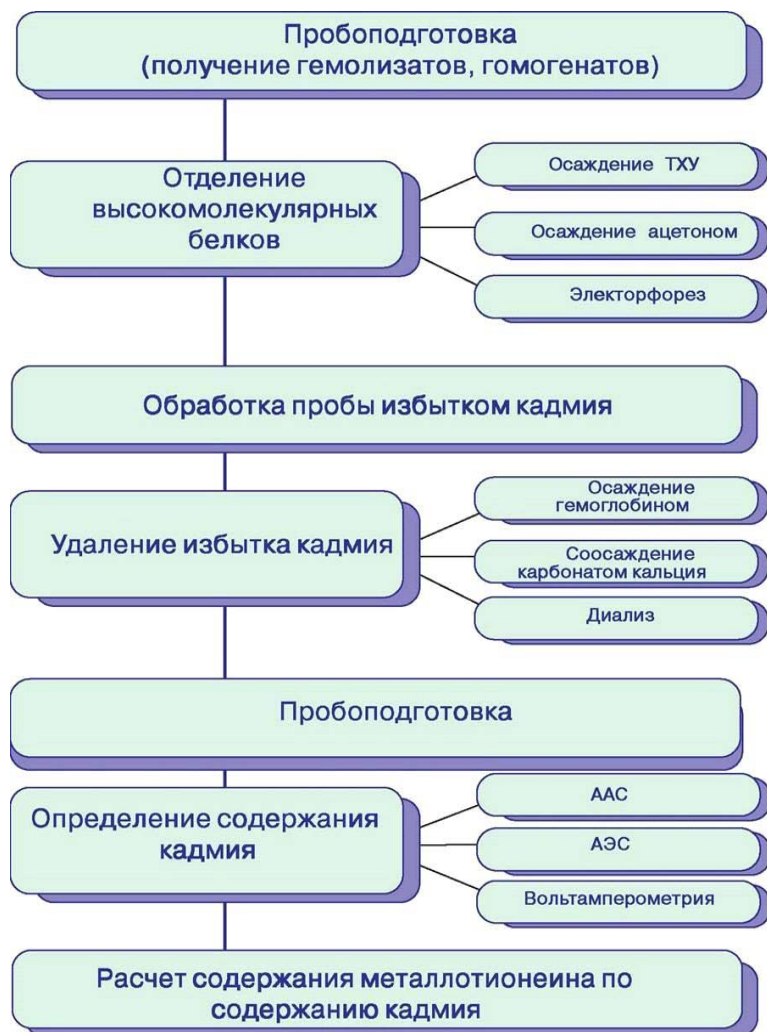
Рис. 25. Принципиальная схема количественного определения содержания металлотионеина в биосредах методом насыщения.
